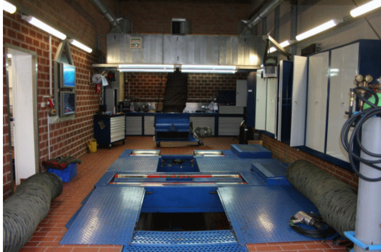
Allradleistungsrollenprüfstand LPS 2000 zur Leistungsmessung oder Lastsimulation
